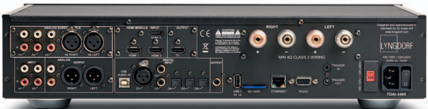
Der Kartenschacht mit der blauen Speicherkarte (unten Mitte) bildet das Backup für alle Filter- und Setup-Einstellungen. HDMI- und Analog-Modul (links oben) sind hier montiert, der symmetrische Ausgang (links unten) zählt zur Standardausrüstung.
